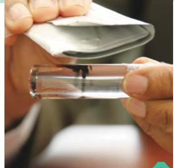
▲ 磁石に反応する磁性粒子。
