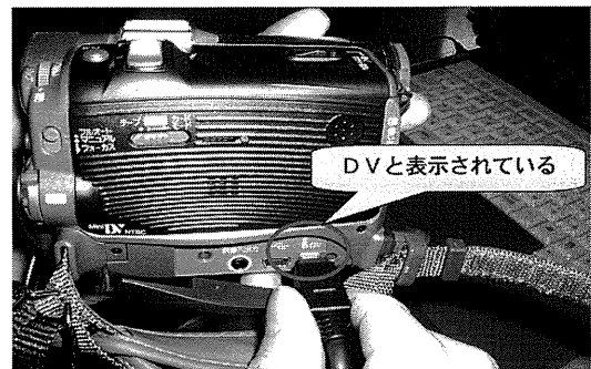
DVカメラとケーブルを接続する
